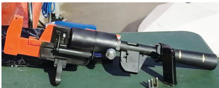
Рис. 6. Действующий опытный образец аварийно-спасательного инструмента с пиропроводом
