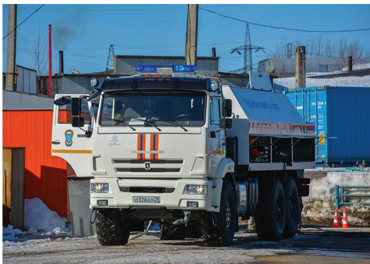
Рис. 2. Мобильный комплекс специальной обработки (МКСО). Авторазливочная станция повышенной проходимости МКСО представляет собой комплект специального оборудования, смонтированного на автомобиле КамАЗ-43118 [3]. Работа авторазливочной станции основана на размещении специального оборудования на шасси высокой проходимости
