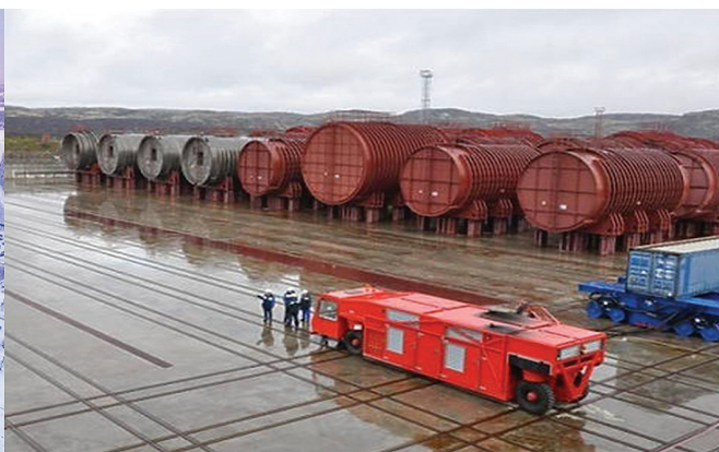
Рис. 4. Пункт размещения реакторных отсеков
