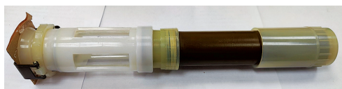
Рис. 2. Насос от прибора ВПХР с прикрепленной насадкой и установленным противодымным фильтром 4
