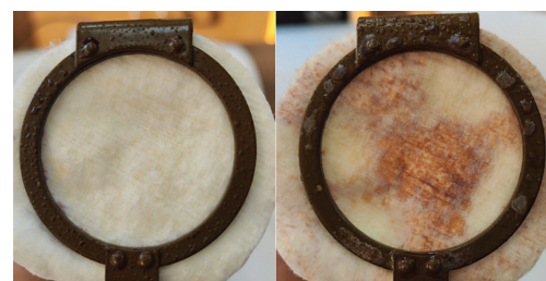
Рис. 4. Слева — установленный в насос ватный диск с нанесенной рецептурой АУ-9/1. Справа — результат после прокачивания при распылении имитационной рецептуры АУ-9ск в концентрации 1% и нанесения индикационной рецептуры АУ-9/2 6
