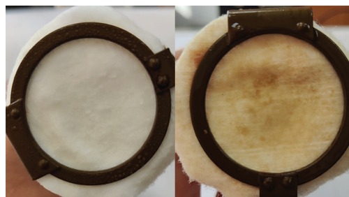
Рис. 5. Слева — установленный в насос ватный диск с нанесенной рецептурой АУ-9/1. Справа — результат после прокачивания при распылении имитационной рецептуры АУ-9ск в концентрации 0,1% и нанесения индикационной рецептуры АУ-9/2 7
