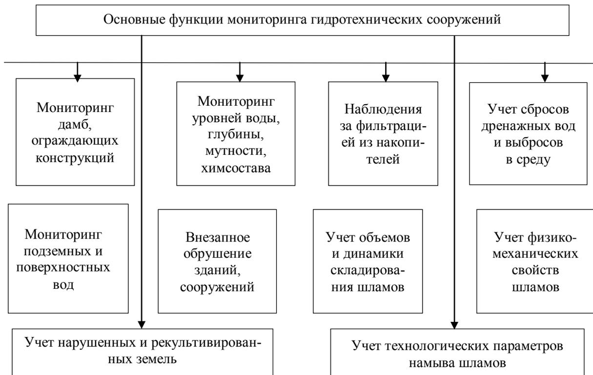
Рисунок 2.3. Основные функции системы мониторинга гидротехнических систем
