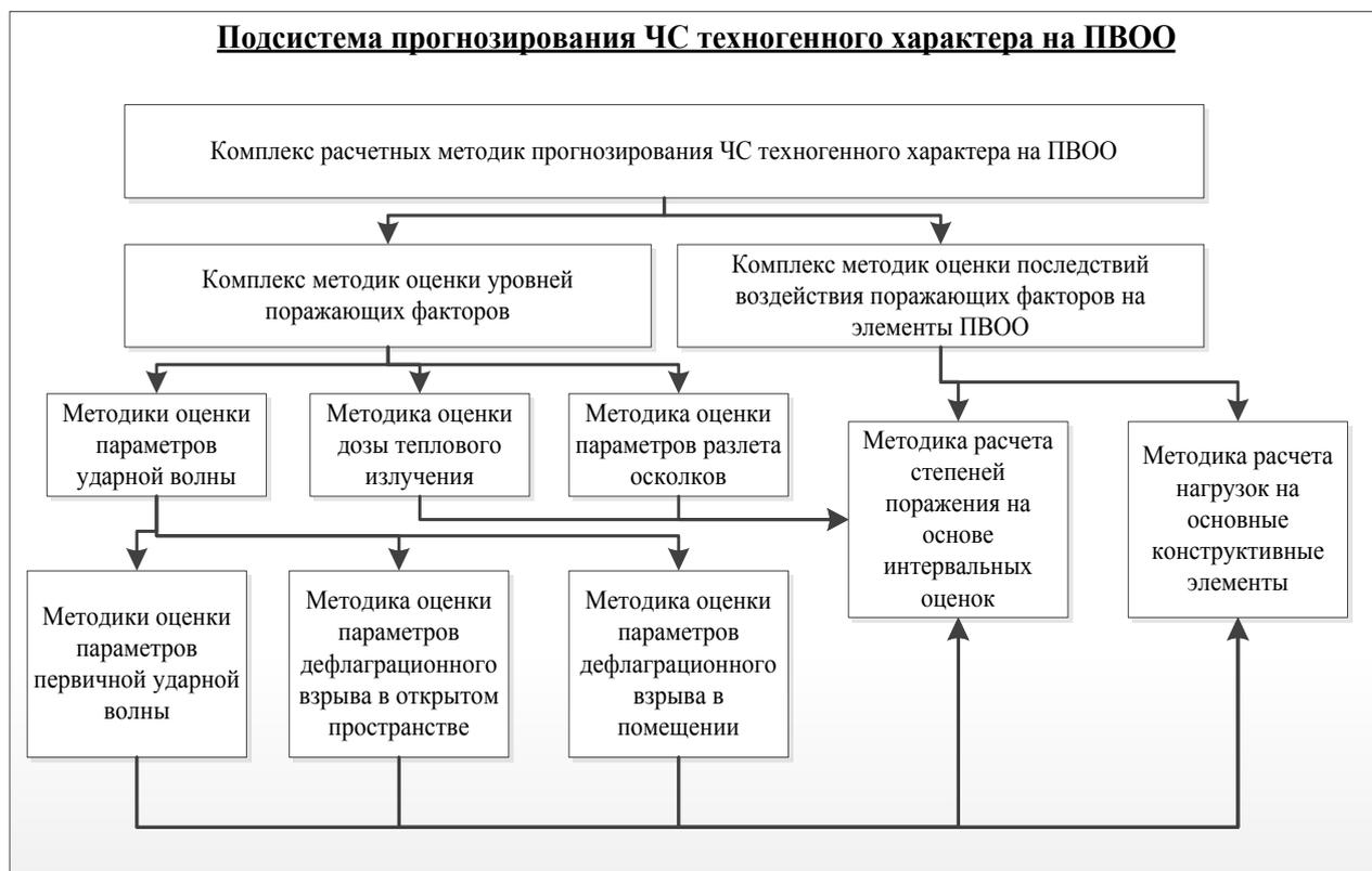
Рисунок 4.20. Общая структура подсистемы прогнозирования чрезвычайных ситуаций техногенного характера на пожаровзрывоопасном объекте [1]
