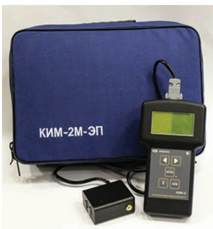
Рис. 7. Коэрцитиметр для измерения силы тока размагничивания образцов
