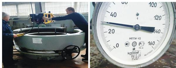
Рис. 10. Испытания образца в камере давления
