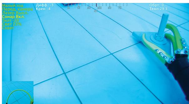
Рис. 7. Захват предмета манипулятором
