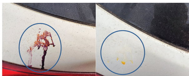
Рис. 3. Проверка наличия соединений урана на окрашенной поверхности кузова автомобиля. Слева — проба с имитатором соединений урана АУ-9ск, справа — чистая проба
