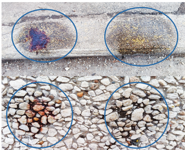
Рис. 4. Проверка наличия соединений урана на различных бетонных поверхностях (бордюрный камень, стена дома). Слева — проба с имитатором урана АУ-9ск, справа — чистая проба
