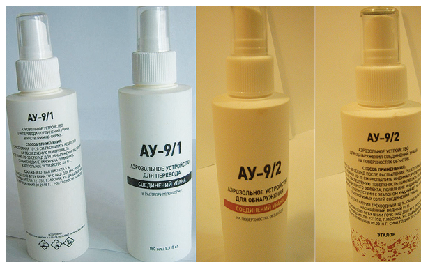
Рис. 1. Аэрозольные устройства АУ-9/1 — для перевода нерастворимых соединений урана в растворимую форму (слева) и АУ-9/2 — для обнаружения соединений урана (справа)
