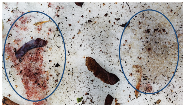
Рис. 9. Проверка наличия соединений урана на поверхности снега. Слева — проба с имитатором урана АУ-9ск, справа — чистая проба
