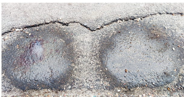
Рис. 5. Проверка наличия соединений урана на поверхности асфальта. Слева — проба с имитатором АУ-9ск, справа — чистая проба
