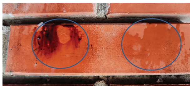
Рис. 8. Проверка наличия соединений урана на поверхности красного кирпича. Слева — проба с имитатором урана АУ-9ск, справа — чистая проба
