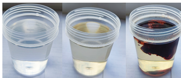
Рис. 10. Проверка индикационного эффекта аэрозольных устройств АУ-9/1 и АУ-9/2. Слева — чистая проба без рецептур, в центре — проба с внесенными рецептурами АУ-9/1 и АУ-9/2 (чистая проба), справа — проба с имитатором урана АУ-9ск
