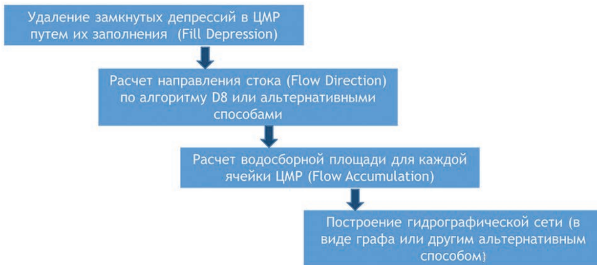
Рис. 1. Общий алгоритм подготовки ЦМР для выполнения задач моделирования наводнений
