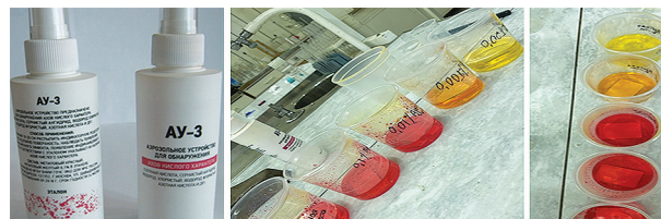
Рис. 3. а) АУ-3 (вид спереди и сзади) и индикационный эффект от различных концентраций веществ кислого характера (азотной кислоты); б) вид спереди; в) вид сверху
