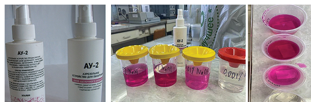
Рис. 2. а) АУ-2 (вид спереди и сзади) и индикационный эффект от различных концентраций веществ щелочного характера (гидроксида натрия); б) вид спереди; в) вид сверху
