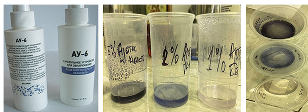
Рис. 4. а) АУ-6 (вид спереди и сзади) и индикационный эффект от различных концентраций веществ окислительного характера (азотной кислоты); б) вид спереди; в) вид сверху
