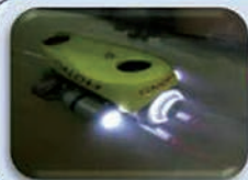
Малогабаритный телеуправляемый подводный аппарат сверхлегкого типа «ГНОМ» (совместно с ФГБУН «Институт океанологии им. П.П. Ширшова РАН»)
