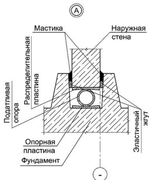
Рис. 3. Узел сопряжения наружных вертикальных стен с фундаментом в бескаркасных и каркасных ЗС ГО
